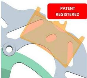
Il diametro esterno e quello interno del disco hanno un design non tondo che permette una migliore espansione radiale del disco in condizione di calore estremo. Inoltre, i fori di alleggerimento sono sostituiti da spigoli progettati specificatamente per migliorare il processo di rinnovamento delle pastiglie.</p> |
